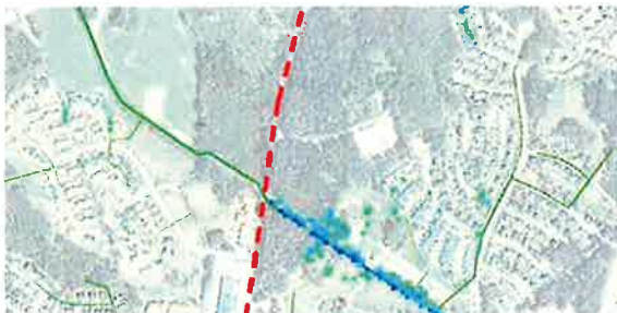
Kartan visar översvämnning vid 10-årsregn, från Dagvattenmodellering Katrineholm, DHI 2018-01-18. Bievägen är markerad med röd streckad linje.
