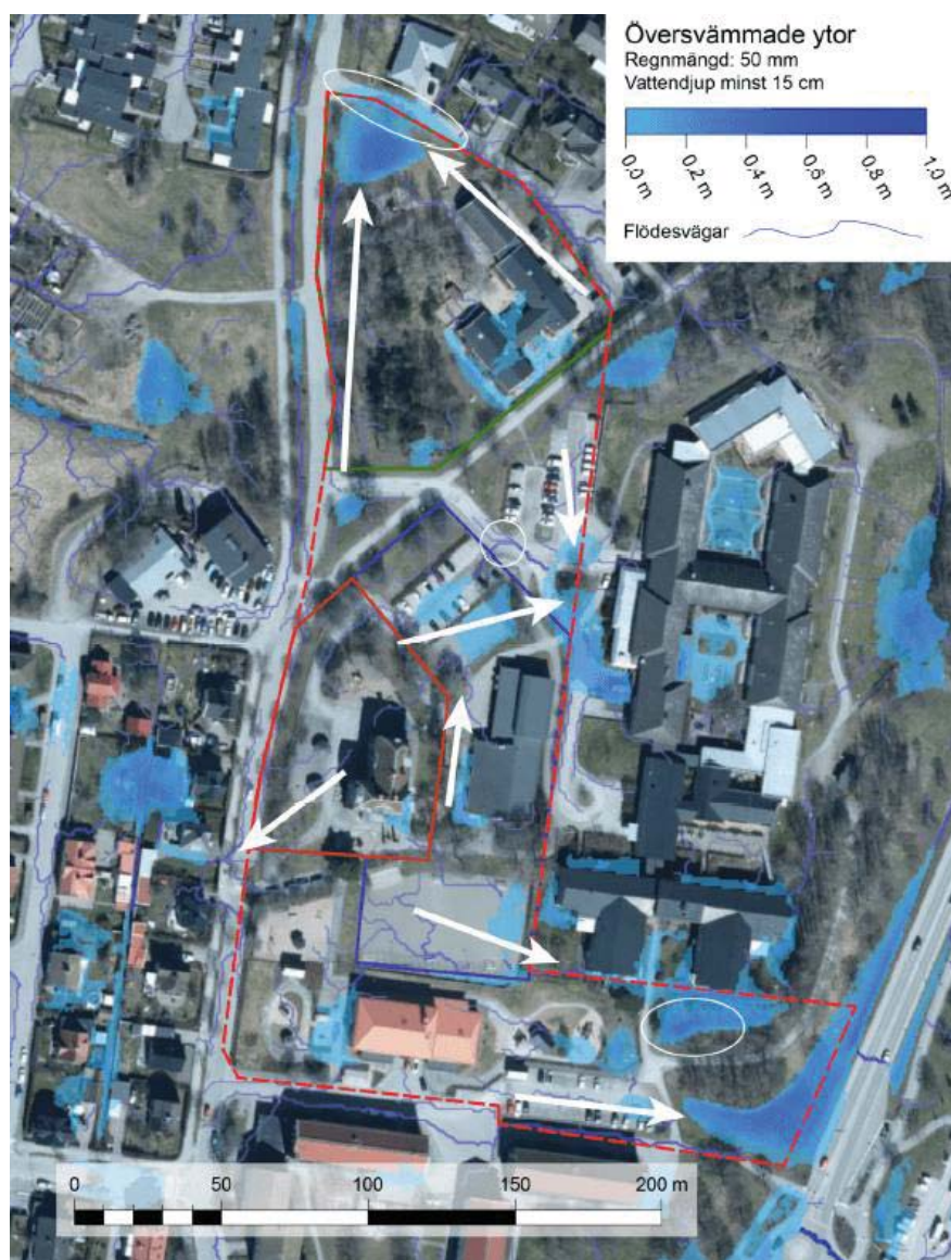
Figur 18: Projicering av befintliga skyfallsvägar och översvämningsytor via SCALGO. Skyfallsimuleringen gjordes med en regnmängd på 50 mm och ett vattendjup på minst 15 cm för att visualisera flödesvägar och ansamlingspunkter för vatten vid ett skyfall enligt SMHIs definition. Vita pilar visar flödesriktningar och vita cirklar lågpunkter.
